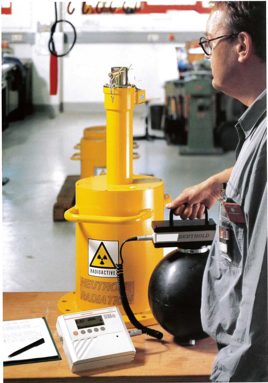
Einsatz der Sonde LB 6411 als tragbarer Monitor beim Ausmessen der Neutronen-Dosisleistung an einer industriellen Am-Be-Quelle zur Feuchtebestimmung.
